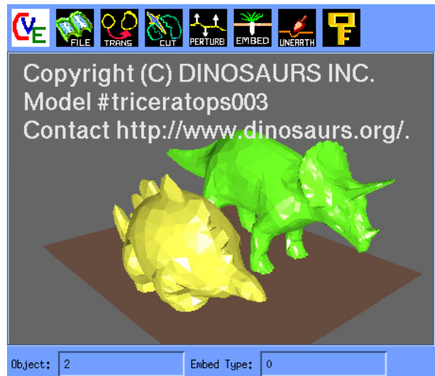
図1. 本シーンの 2体の恐竜のモデルにはそれぞれ異なるコピーライト告知が埋め込んである. この情報はモデルをクリックすることにより掘り出し, 表示できる.
