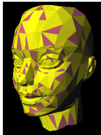
図7. TVR アルゴリズムで透かしを埋め込んだ例. 埋め込みに使われた 3 角形達は濃い灰色でレンダリングされている.
