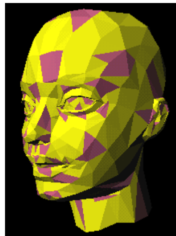
図5. TSQアルゴリズムでデータを埋め込んだモデル。マクロ埋め込みプリミティブをなす3角形の4つ組みは濃い灰色で示されている。
